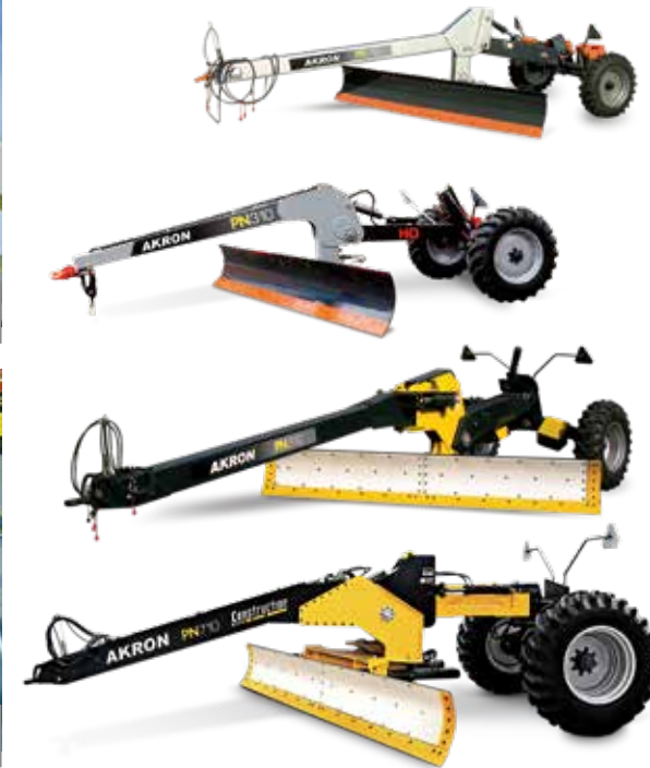
ACCIONAMIENTO HIDRÁULICO DE DESPLAZAMIENTO LATERAL EN 510 Y 710.
