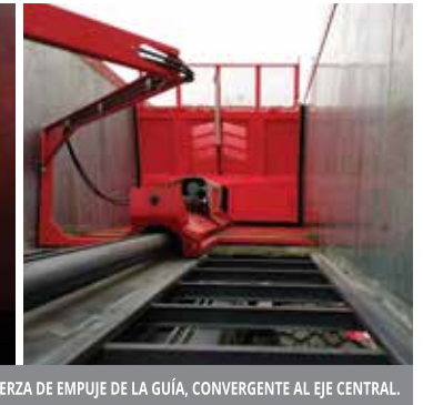
PISO DESPLAZABLE QUE MEJORA AUTOLIMPIEZA. FUERZA DE EMPUJE DE LA GUÍA, CONVERGENTE AL EJE CENTRAL.
