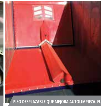
PISO DESPLAZABLE QUE MEJORA AUTOLIMPIEZA. FUERZA DE EMPUJE DE LA GUÍA, CONVERGENTE AL EJE CENTRAL.
