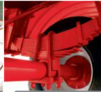
ROBUSTO TREN RODANTE CON ELÁSTICOS SEMIELÍPTICOS.
