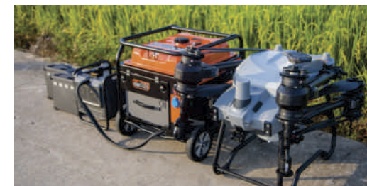
BATERÍA, CARGADOR Y GENERADOR
